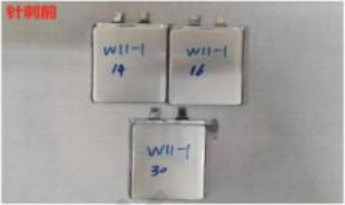
NCMA86 中孚隔膜电池在90% SOC 状态下能通过3mm。 2024年4月
